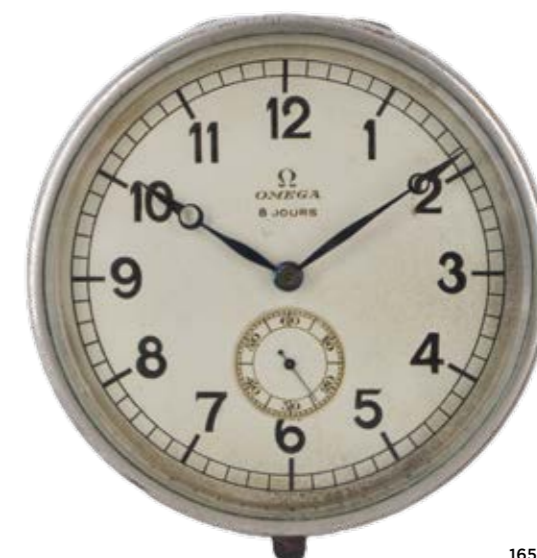
165. OMEGA Pendulette de bord pour automobile - Référence MA 300. Pendulette à remontage manuel. Cadran rond blanc, index chiffres arabes noirs peints, minuterie chemin de fer noire peinte, aiguilles pommes ajourées bleuies, petite seconde à 6H, logo peint. Mouvement : mécanique à remontage manuel. Calibre 59 8-D CLEF 15 rubis - Numéroté 6668838 (vers 1929). Mouvement et cadran signés. Dimensions du boîtier : 84 mm.
